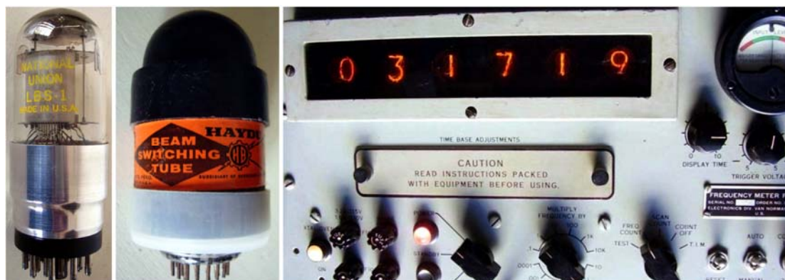
Fig. 04 - Da sinistra, un selettore beam switch LBS-1 , precursore del trochotron, ed un esemplare dei primi trochotron 6700 con magneti esterno prodotto dalla Haydu Brothers, su progetto Burroughs. A destra un frequenzimetro digitale FR-114/U , utilizzando sei tubi trochotron, le cui uscite pilotano altrettanti indicatori di tipo 6844 Nixie .
