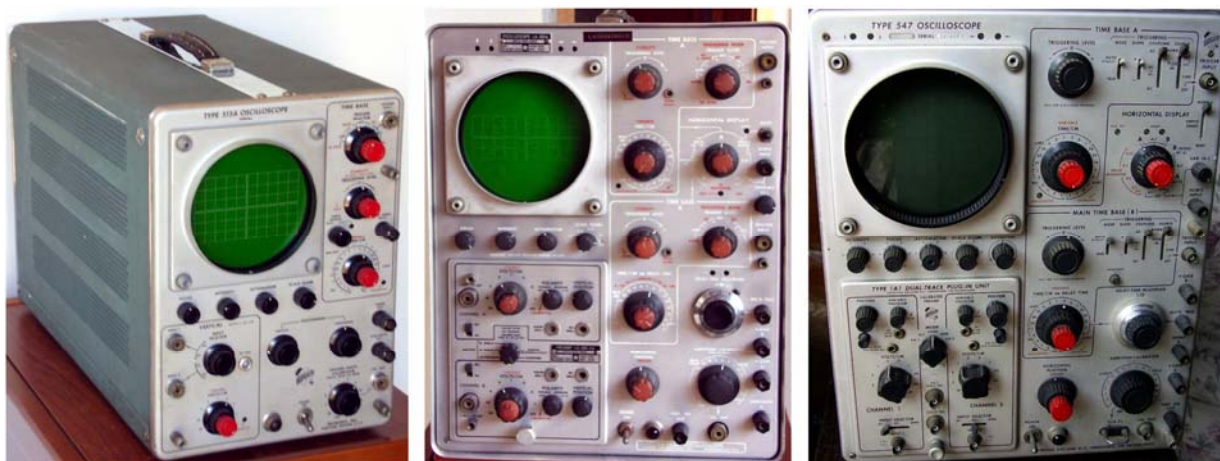
Fig. 05 - Oscilloscopi Tektronix. Il primo da sinistra è un piccolo 515A adatto per il service. Il Lavoie LA-265 era un clone del Tektronix 545, con doppia base dei tempi ed amplificatore verticale a costanti distribuite con oltre 30 MHz di banda passante. Il terzo oscilloscopio è uno dei 547 usati dal compianto Professor Angelo Luciano, colui che fece comprendere a tanti i segreti dell'elettronica. Lo strumento era stato in parte cannibalizzato, ma il restauro è quasi ultimato.
