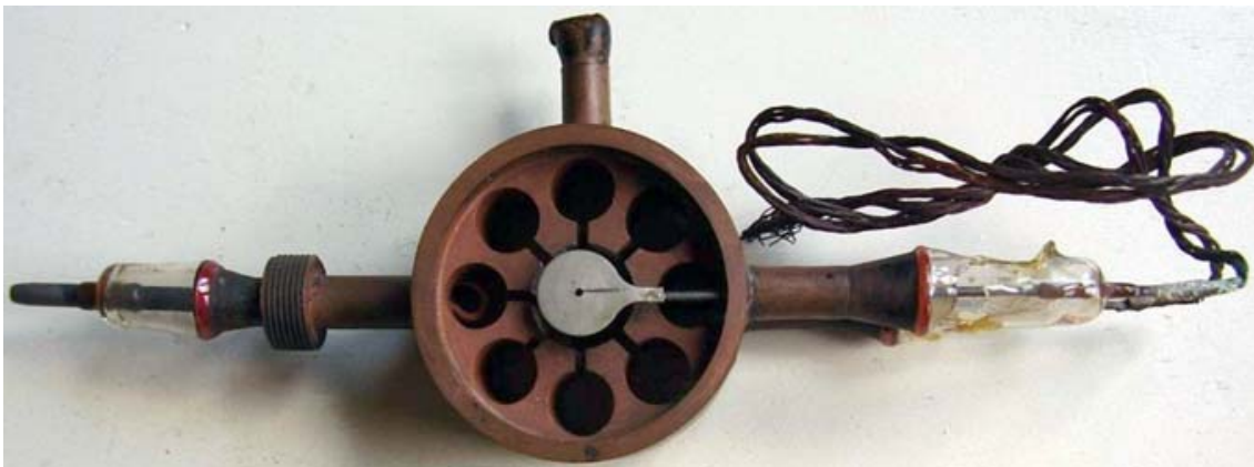
Primo esemplare prototipico del magnetron E.1198 ad otto cavità realizzato da Megaw alla GEC nel luglio 1940.
