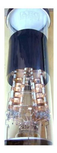
Dual gun oscilloscope CRT.
